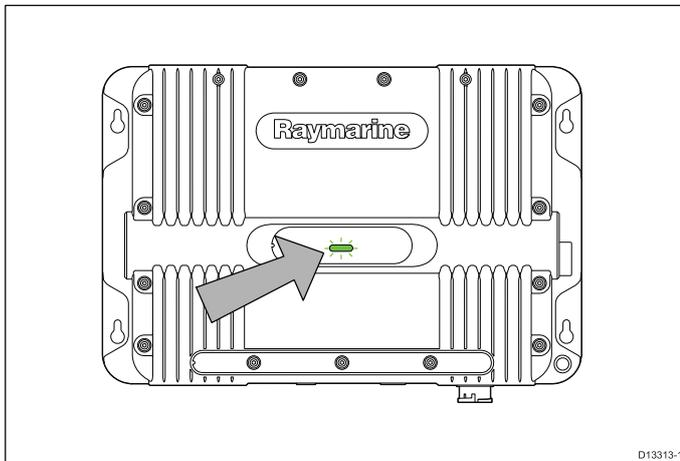
Le LED témoin sur le panneau avant de l'unité donne des indications sur l'état du module sondeur et prévient les utilisateurs en cas de problème avec l'unité. Le LED témoin clignote dans les couleurs suivantes :
